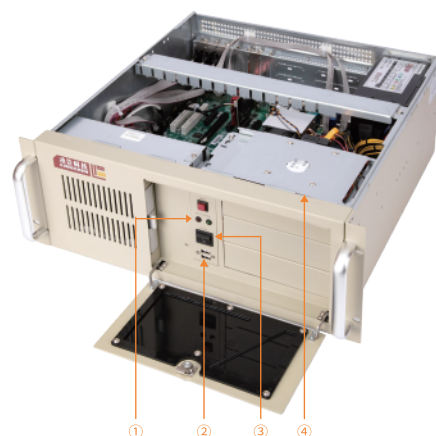
①.LED指示灯 ②.前置USB ③.Power SW ④.硬盘支架和光软驱支架
