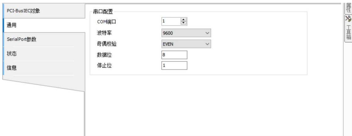
注意，端口号要和硬件连接的端口对应，如选 232，则端口号为 1，选 485，端口号为 2。
